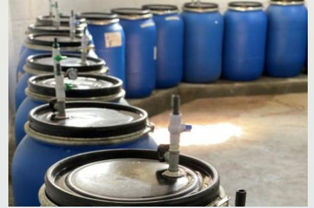
精選工程で使用するプラスチックバレル
